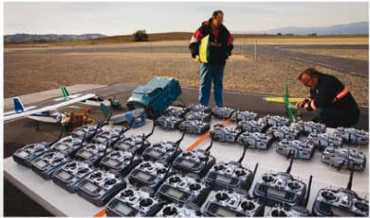
Preparación para la prueba con 40 emisoras Spektrum encendidas de forma simultánea
